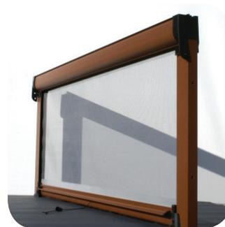
L'installation de la moustiquaire ROCHFLEX est très simple, elle se fixe dans la partie haute de l'encadrement fenêtre par les deux embouts de caisson télescopiques, ceux-ci pourront, le cas échéant, récupérer un jeu de fonctionnement, afin de minimiser l'emploi de mastic silicone. Un feutre brosse inséré sur la partie supérieure du caisson viendra parfaire l'étanchéité lors de l'installation.
